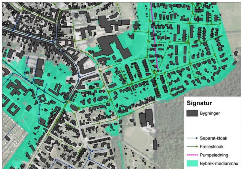
Figur 3-3 Områder der ligger lavere end vandspejlet i Bybækken ved medianmaksimum. Der kan ske oversvømmelser opstrøms Skovbrovej/Skovvej og i om-
