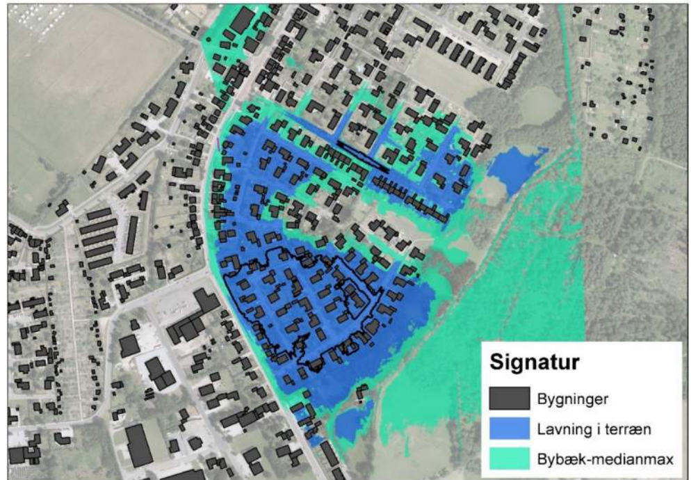
Figur 3-1 Dyrehavekvarteret. Grøn er arealer, der ligger lavere end Bybækkens vandspejl ved medianmaksimum. Blå arealer viser lavninger inden for oversvømmelsesområdet. De sorte kurver angiver de dybeste lavninger. Såfremt afløbssystemet overbelastes vil det være ejendomme i bunden af lavningerne som vil opleve problemerne først.
